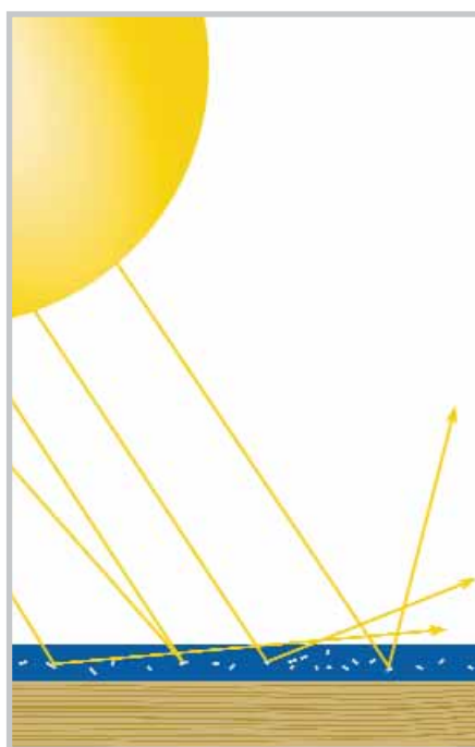
Złe ułożenie drobin metalu w zwyczajnych lakierach efektowych: efekt metaliczny jest mało wyrazisty.
