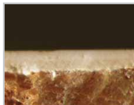
Powierzchnia o małej zawartości mikropiany dzięki powłoce z Induline LW-700.
