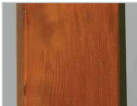
Bez zastosowania Induline SW-900: plamienie.
