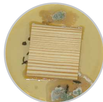
Szalka testowa 2: Drewno zaimpregnowane środkiem Induline SW-900.
