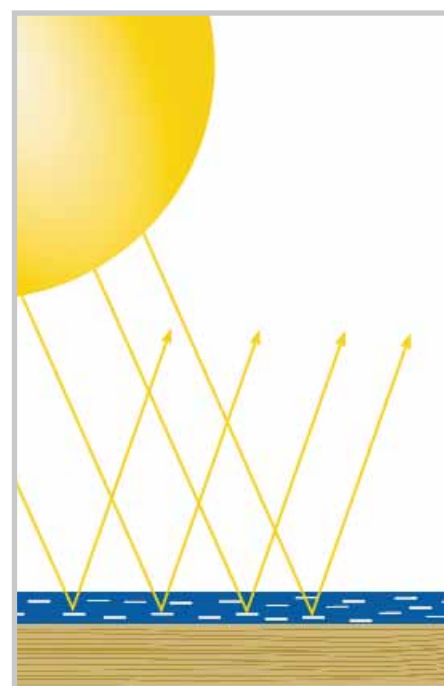
Optymalne ułożenie drobin aluminium w Induline ZW-420: równomierne odbijanie światła – wyrazisty efekt metaliczny.
