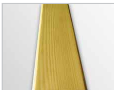
Zwykła bezbarwna lazura do okien powoduje wyraźne żółknięcie na drewnie iglastym (barwa własna spoiwa).
