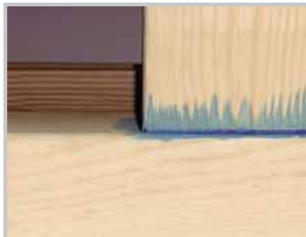
Zwyczajny impregnat nie jest w stanie powstrzymać nasiąkania drewna wodą przez przekrój czołowy elementu.
