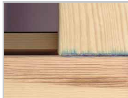
Hydrofobizujące działanie Induline SW-900: skuteczne zabezpieczenie przed wilgocią.
