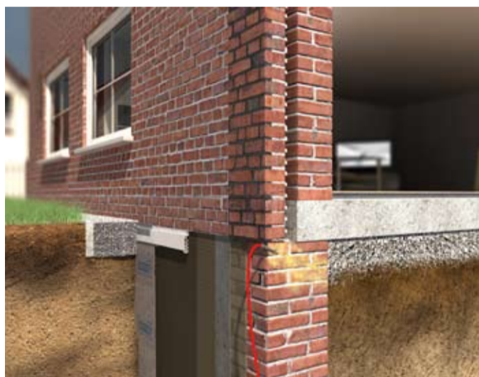
Uszczelnienie i połączenie wykonane z Multi - Baudicht 2K - nowe spoinowanie budowli i impregnacja cokołu z murze licowym
