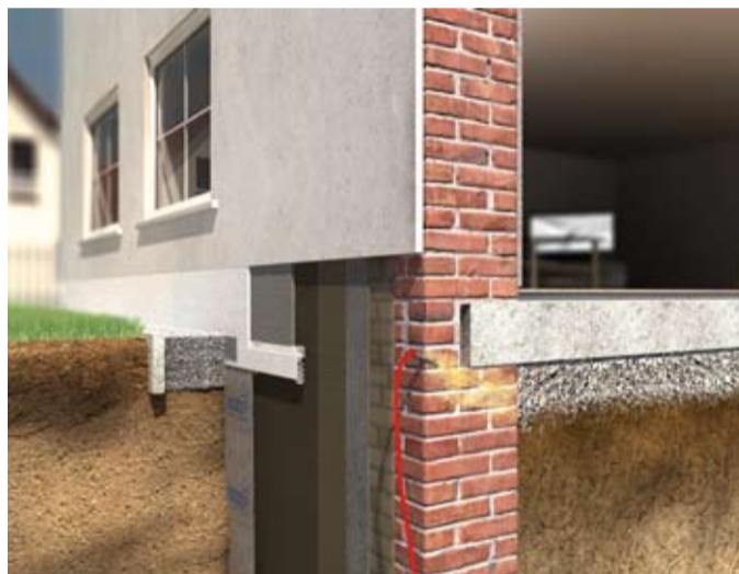
Uszczelnienie z Multi - Baudicht 2K bez zakładki i dodatkowego zabezpieczenia tynku cokołowego przed wilgocią podciąganą kapilarnie.
