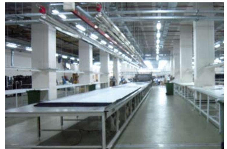
Na stołach konfekcyjnych wykonywane są wykroje dżinsów
